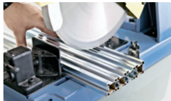
↑ Een cirkelzaag kan maximaal vier Geberit GIS profielen op hetzelfde moment op lengte zagen.
